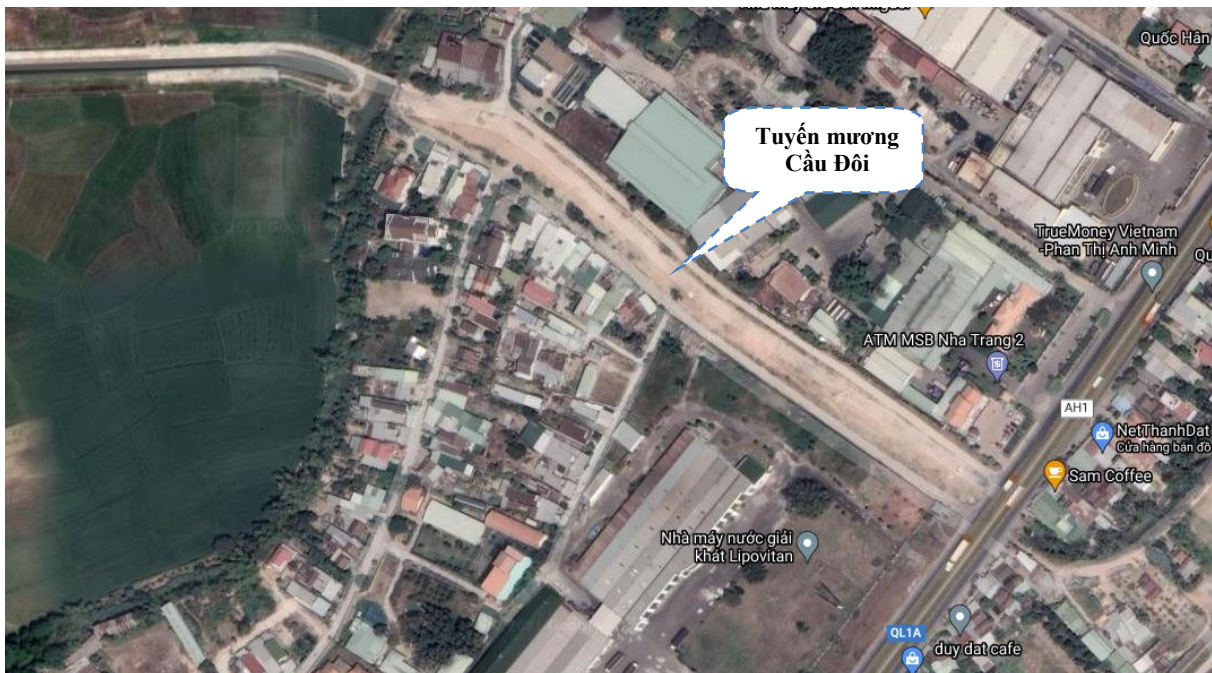
Hình 14. Hiện trạng tuyến mương Cầu Đôi đã được hạ ngầm đoạn phía Bắc dự án bằng tuyến cống D1.500 (mm)
